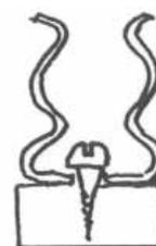
6. Forare il blocchetto secondo disegno ( $\varnothing 3$  e  $\varnothing 1,5$  mm).
